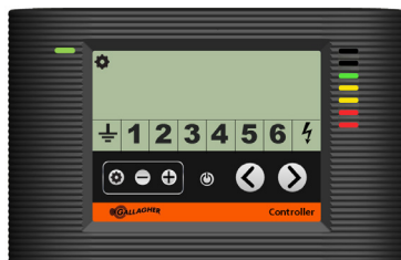
Controlador mostrando a tensão de saída sendo ajustada
