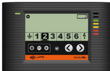
Controlador exibindo a zona 2 com bateria fraca
